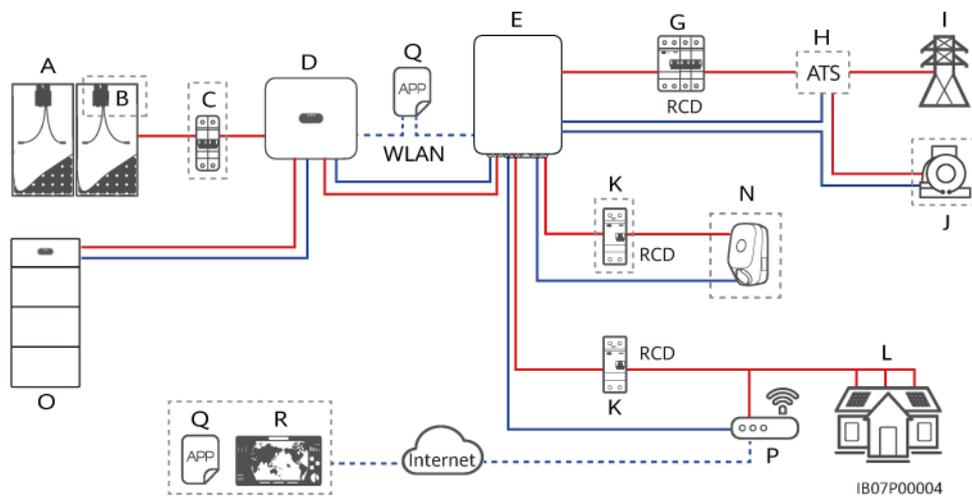
**Figura 2-5** Collegamento in rete con alcuni carichi collegati a SmartGuard (i riquadri tratteggiati indicano i componenti opzionali)
