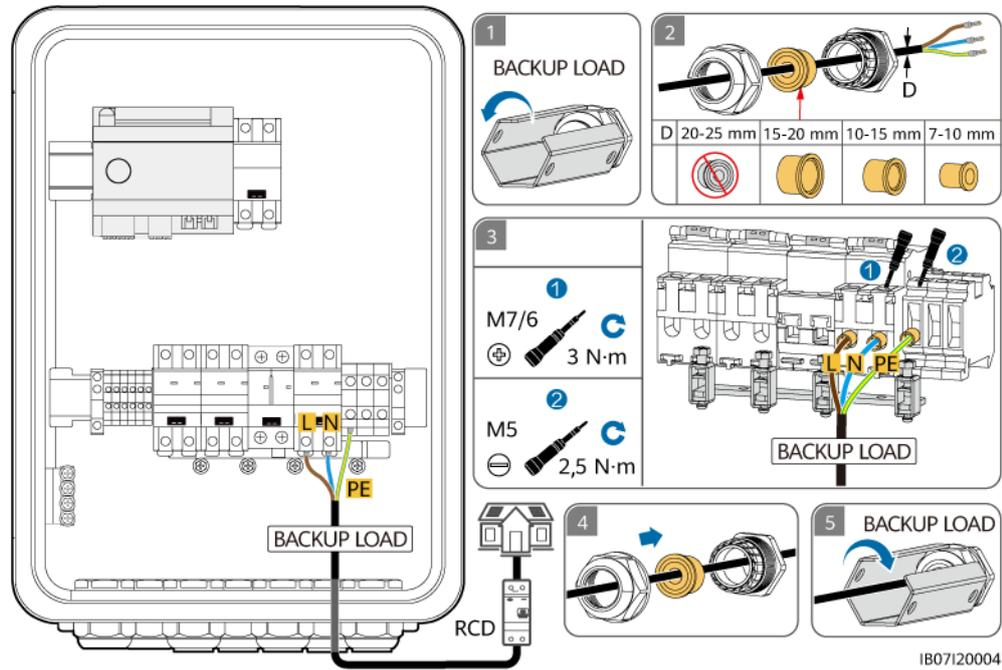
**Figura 5-15** Collegamento del cavo di alimentazione di uscita del carico di backup di SmartGuard-63A-AUS0
