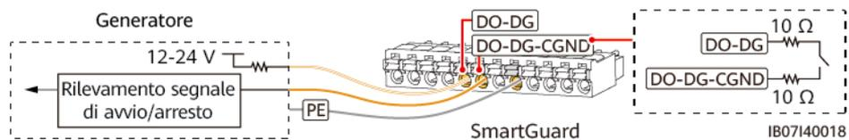
**Figura E-2** Segnale di allarme del generatore
